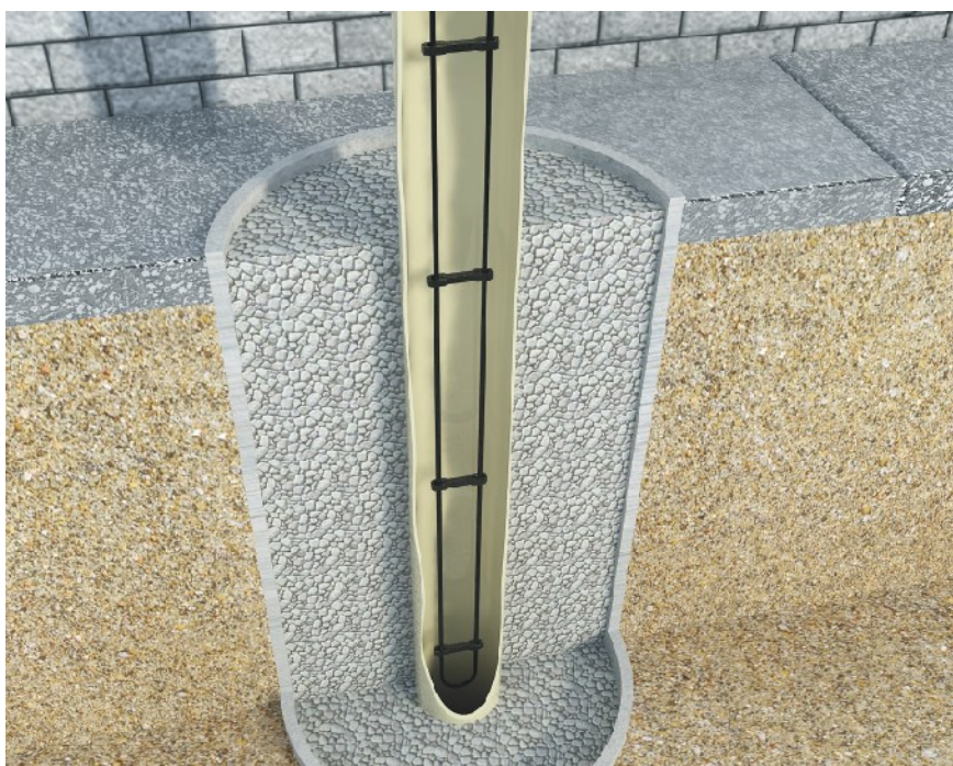
Расположение нагревательного кабеля от уровня земли до глубины промерзания грунта
