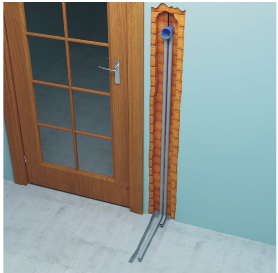
Монтаж гофрированных трубок
