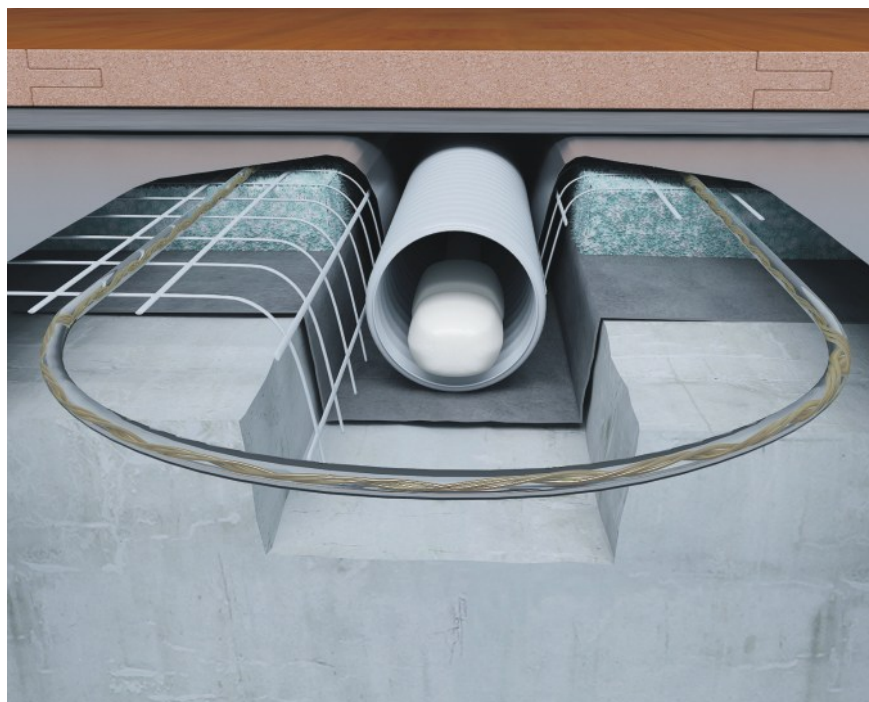
Установка датчика температуры (глубина желоба должна составлять 10-12мм)
