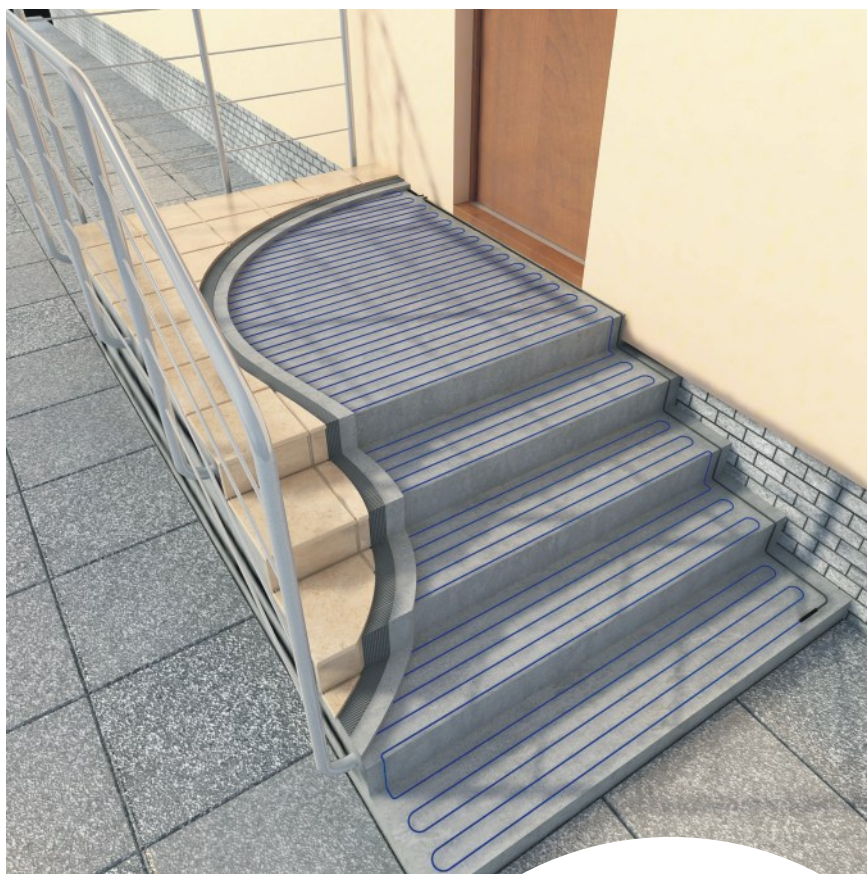
Расположение одножильного нагревательного кабеля ELEKTRA VC20
