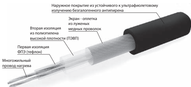
Конструкция кабеля нагревательного мата ELEKTRA SnowTec® Tuff
