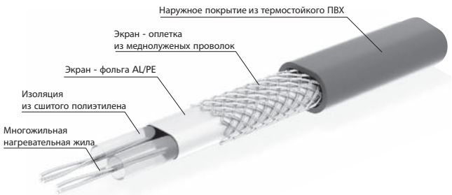
Конструкция нагревательного мата ELEKTRA SnowTec®
