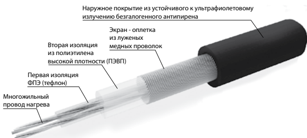
Конструкция нагревательного кабеля ELEKTRA TuffTec™
